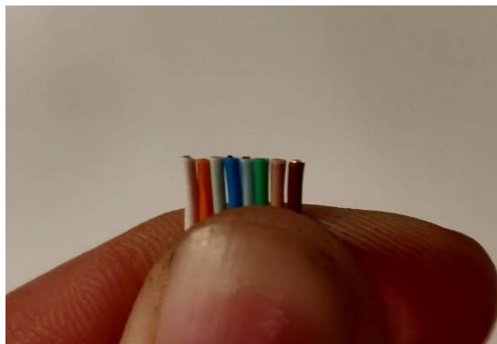
Maintenant que les câbles sont bien triés et normalisés il faut les assembler à notre prise RJ45 en faisant attention à mettre cette prise dans le bon sens.
